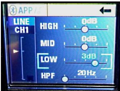
Fig. 12 CH1 Low band EQ, +3 dB
