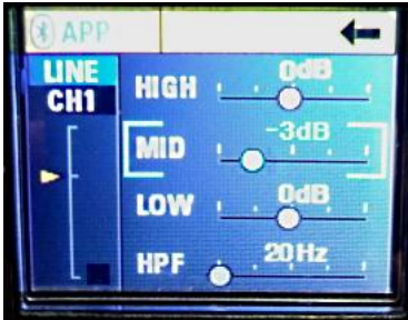
Fig. 10 CH1 Mid band EQ, -3 dB
