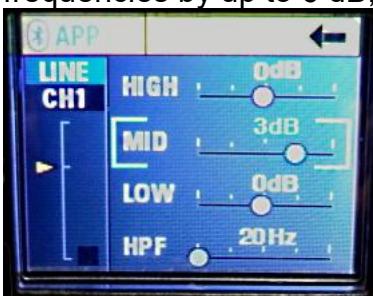
Fig. 9 CH1 Mid band EQ, +3 dB
