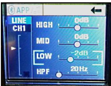
Fig. 13 CH1 Low band EQ, -2 dB
